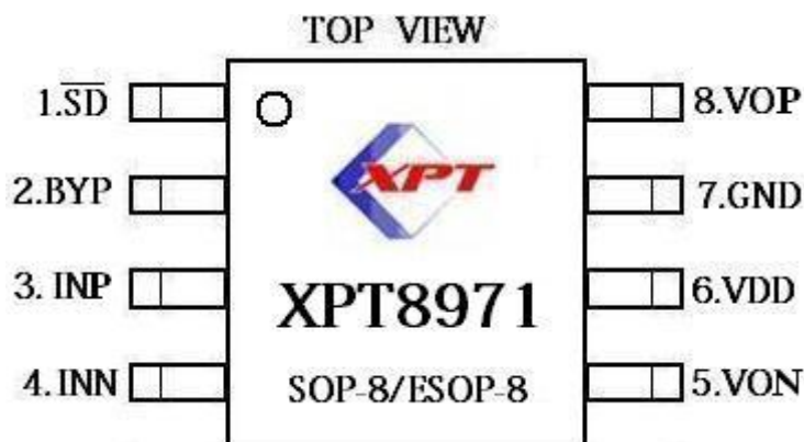
图 1 XPT8971 MSOP8、ESOP、SOP.封装的管脚分布图。
